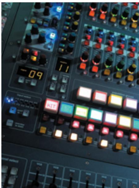
L'ergonomie de la Midas PRO6 est aussi aboutie que le son est superbe. Tous les contrôles ajustables sont de véritables potentiomètres et non des encodeurs. Ils permettent d'accéder au moteur FPGA à travers les convertisseurs A-D et aux algorithmes d'interpolation spécifiques à Midas. Cela signifie que de même que pour l'audio toute action de l'utilisateur est totalement interpolée de manière à lui offrir au mixage une douceur et une linéarité que l'on trouve en analogique.
