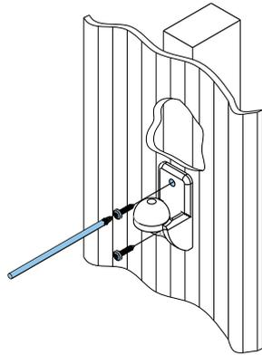
2. À l'aide d'un tournevis cruciforme, serrez **deux (2) vis cylindriques M5 (fournies)** pour fixer le support du haut-parleur à l'arrière de l'enceinte.
