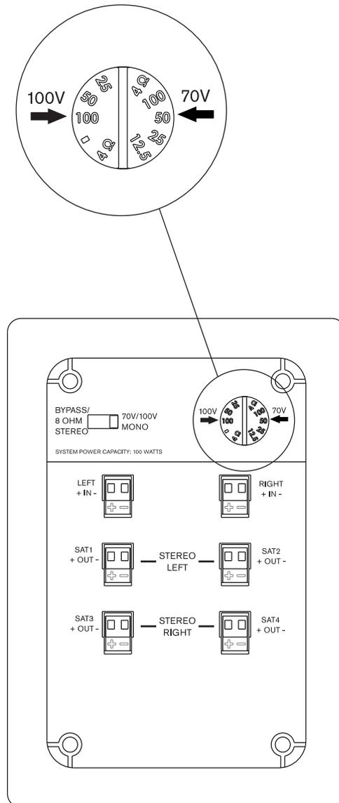
Figure 5.2: EVID 40S Borne de puissance
