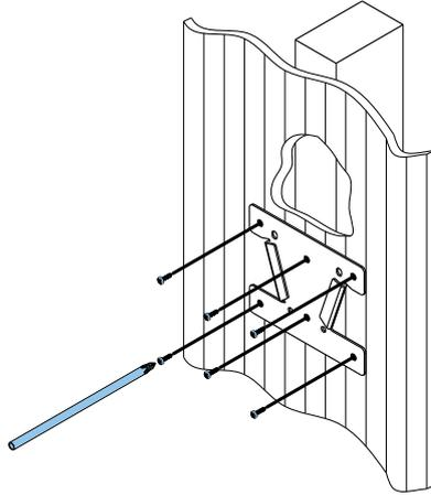
2. À l'aide de la clé hexagonale (fournie), serrez les **trois (3) vis cylindriques à six pans M6** pour fixer le support en V.
