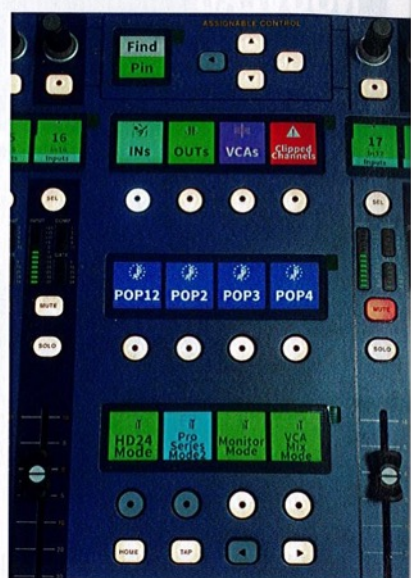
Un panneau central très intuitif de navigation dans les différentes couches de faders.
